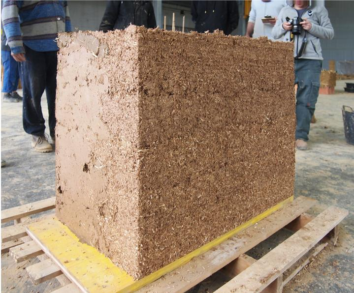
06 Erste Prüfung der CobBauge-Bauweise, durchgeführt in den „Les Grands Ateliers“ (Fr)
